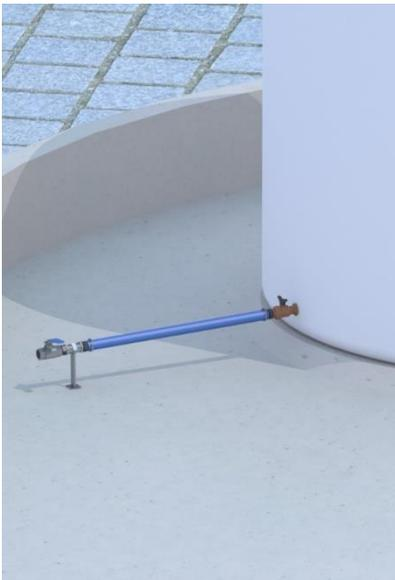
O suporte de tubo deve ser colocado após a conexão flexível para permitir que o tanque se expanda e contraia adequadamente.
